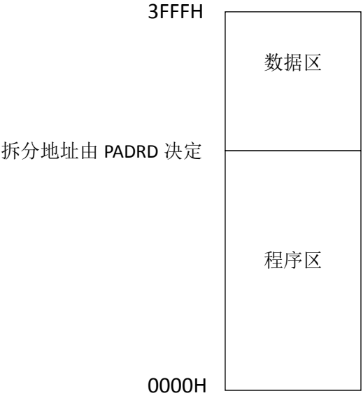
图 7-3-3 16K Flash 存储器结构
