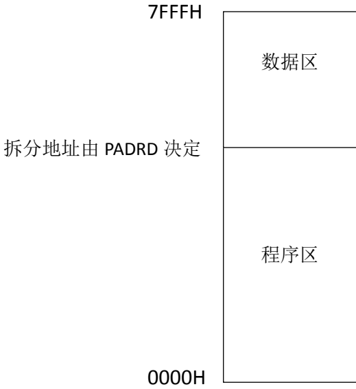
图 7-3-4 32K Flash 存储器结构
