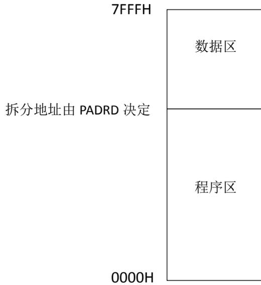
图 7-3-3 32K Flash 存储器结构
