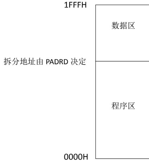
图 7-3-1 8K Flash 存储器结构
