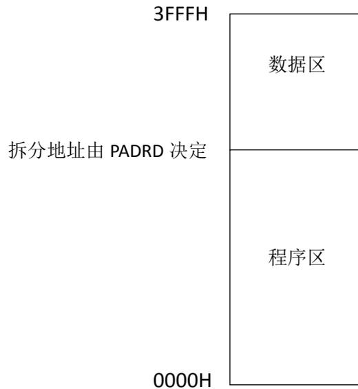
图 7-3-2 16K Flash 存储器结构
