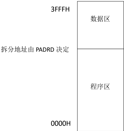
图 7-3-2-1 16K Flash 存储器结构
