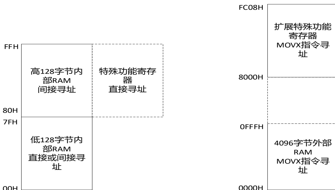
图 7-1-1 RAM 组织结构图
